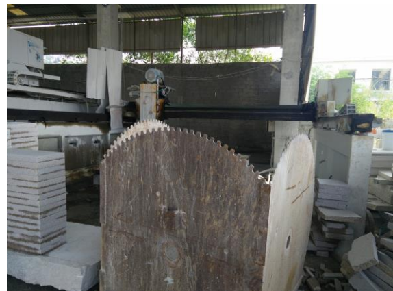
Abgenutzte Sägeblätter werden häufig wiederverwendet, bspw. für Container zum Sammeln von Gesteinsabfällen
