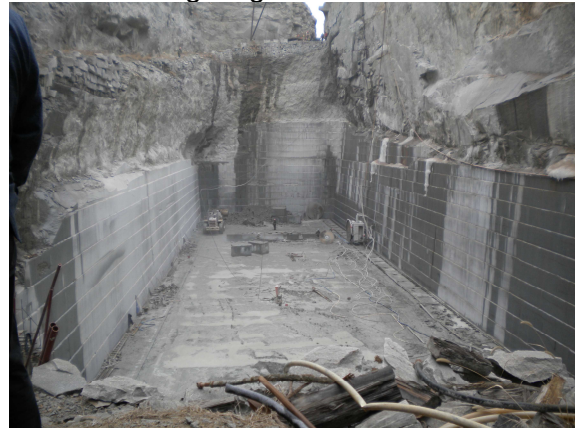
In den Steinbrüchen wird zunehmend mit Seilsägen gesägt. Dies erkennt man deutlich an den sauber geschnittenen Gesteinsbänken.
