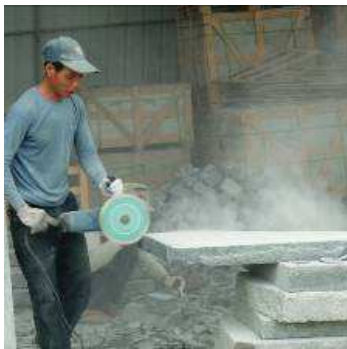
Die Arbeiter tragen keine PSA, obwohl sie einer ständigen Staubbelastung ausgesetzt sind.
