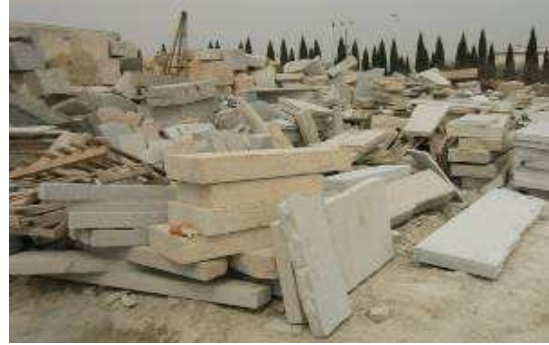
Die Fabrik ist sehr unordentlich. Der Steinschutt auf Wegen kann Unfälle verursachen.
