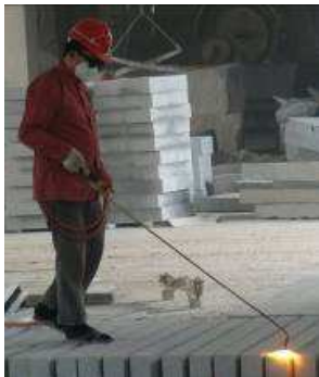
Der Arbeiter flammt mit getönter Schutzbrille.
