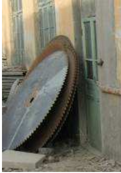
Die Sägeblätter stehen ungesichert an der Mauer.
